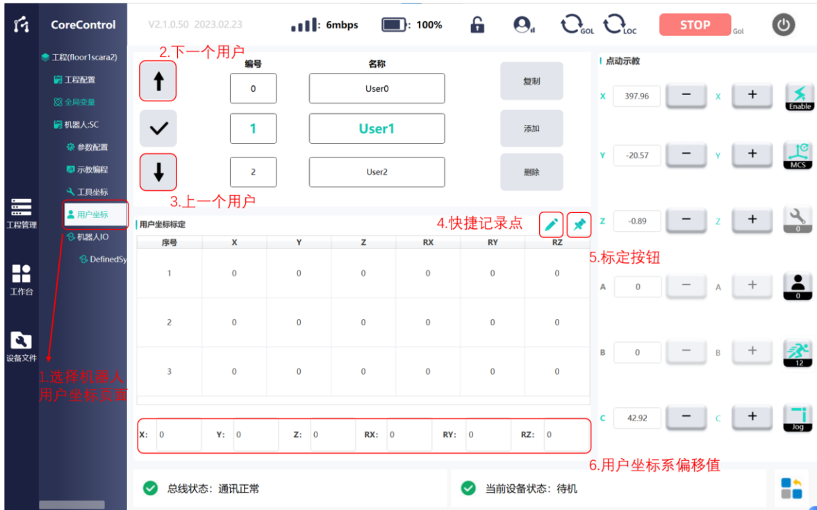
图 64 用户坐标系标定操作
