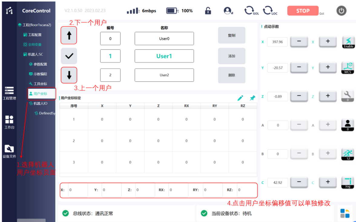
图 65 用户坐标系标定操作
