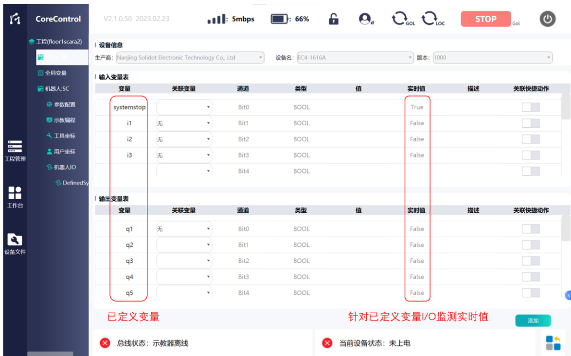
图 23 I/O 变量实时值监测显示
