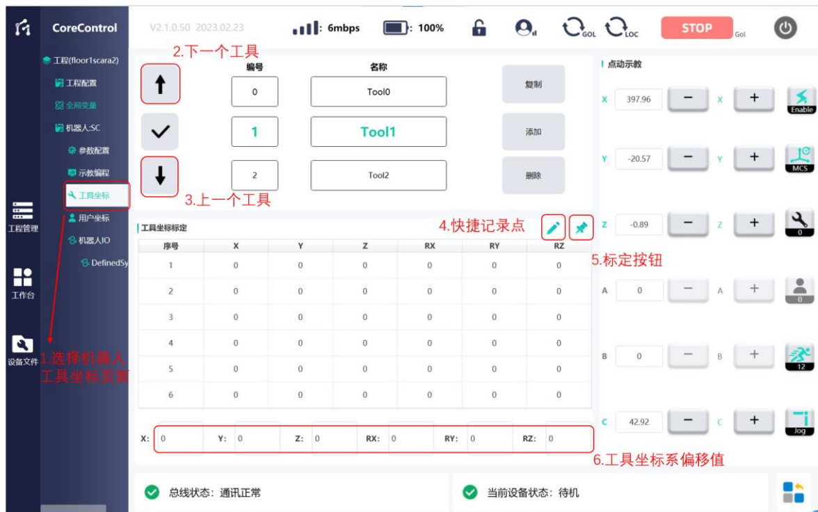
图 59 工具标定操作
