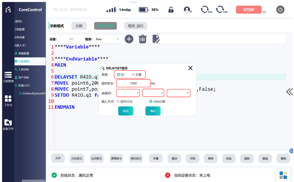
图 112 DELAYSET 逻辑指令使用示例
