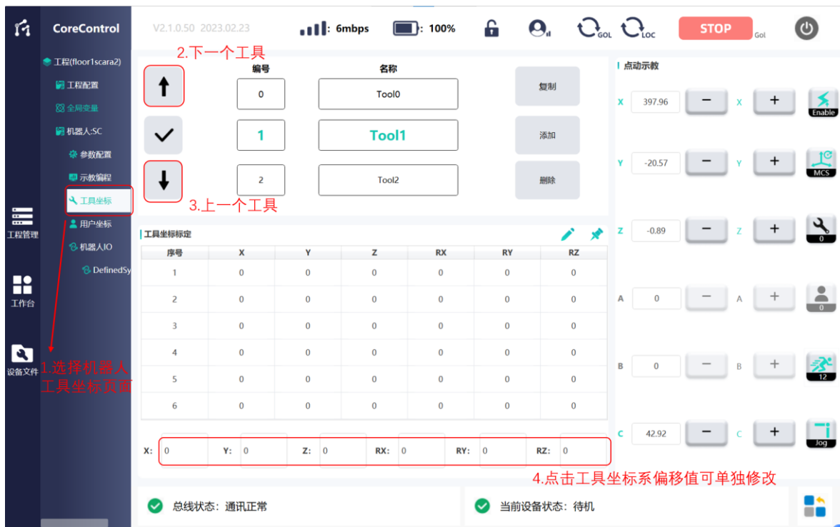
图 60 工具偏移值手动输入操作
