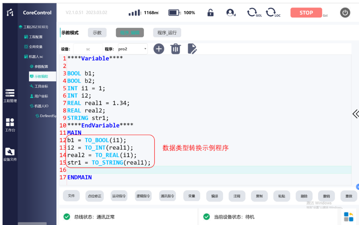
图 97 变量类型转换使用示例
