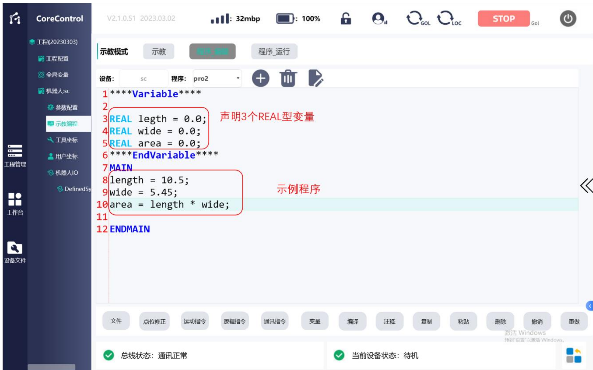
图 95 REAL 型变量使用示例
