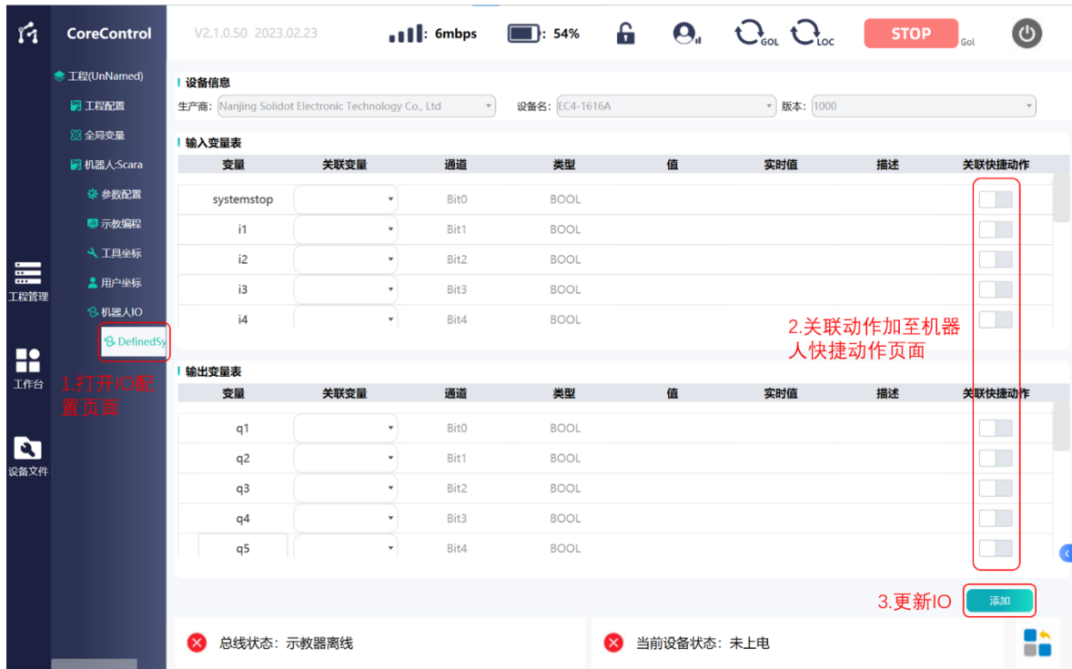
图 74 I/O 关联快捷输入输出
